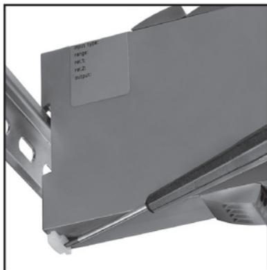
Abb.1: Lösen aus der DIN-Schiene.
